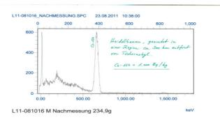
Aus unserer Erfahrung ist es empfehlenswert, Lebensmittel aus Osteuropa (Tschernobyl) stichprobenartig auf künstliche Radionuklide zu prüfen (s. γ-Spektrum, links). Die Reaktorkatastrophe in Fukushima lässt vermuten, dass Importe aus den Anrainerstaaten und Japan selbst in Zukunft erhöhte Radioaktivität aufweisen.
